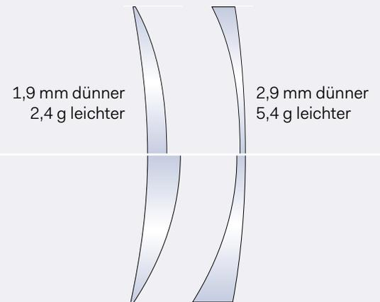
HP 1.5 bei +6,0 dpt: 7,1 mm und 16,9 g | HP 1.5 bei -6,0 dpt: 8,9 mm und 23,5 g | Die Glasschnittdarstellungen beziehen sich auf  $\varnothing$  65 mm.
